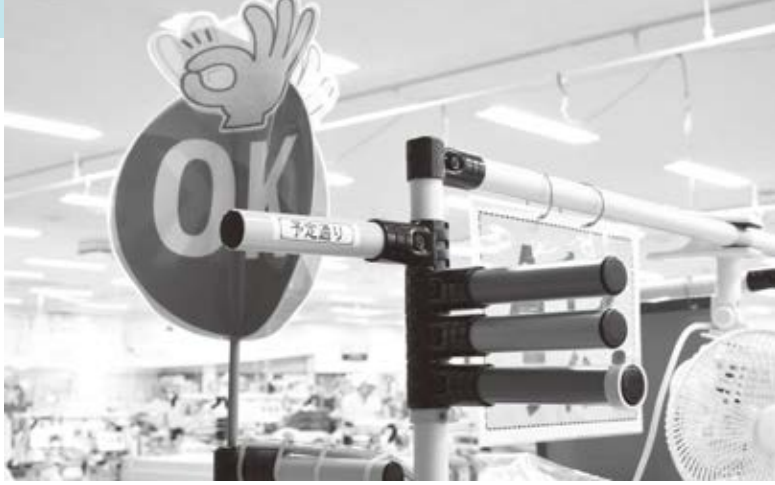
進捗表示バー。 上から、黄「予定通り」、青「先行」、赤「遅れ」、緑「変化点」
