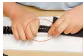
保護ベルト(命綱のこすれ防止)を左図の治具にセットした状態
