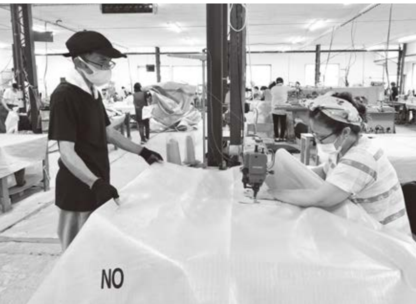
製品が大きいため、二人一組で息を合わせて縫製作業にあたる
