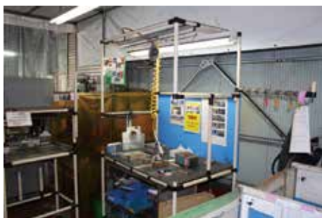
< 紐を引くと、離れた場所にいる指導者に音と点滅ライトで伝達できる >
