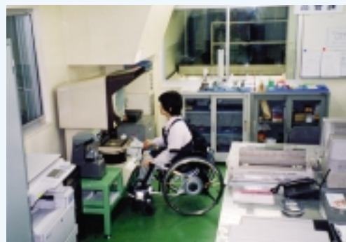
製品の品質を測定する投影機の図面の高さを下肢障害者の目線の位置まで下げ、測定誤差のないように改善。投影機の右後方には各種測定機器類が、車椅子のまま取りだしやすく保管されている。
