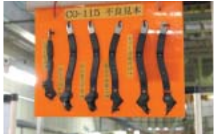
製品ごとに用意されている『不良見本』。これと同じ状態になっていないかを目で確認する。
