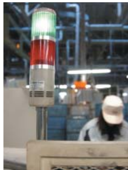
作業者本人にも監督者にも目に付きやすい位置に設置された「装置起動中ランプ」。
