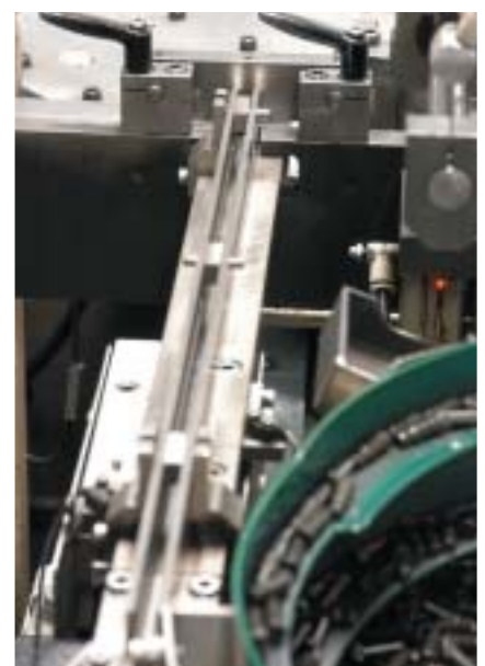
製造部品を送り出すレール。部品切れを知らせるセンサーが組み込まれている。
