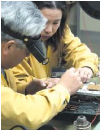
基盤配線検査用テスターはランプと音で表示。聴覚障害者と健聴者がペアで作業する(湖畔工場)。
