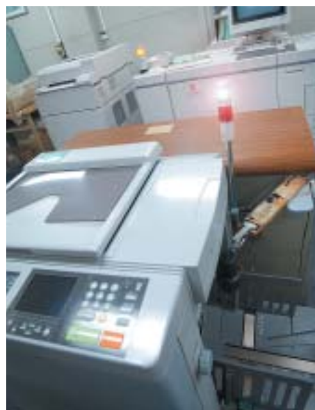
印刷機の使用状況はランプで知らせる。
