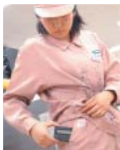
印刷機に異常が起ると、担当者のパイプレーターが作動する。
