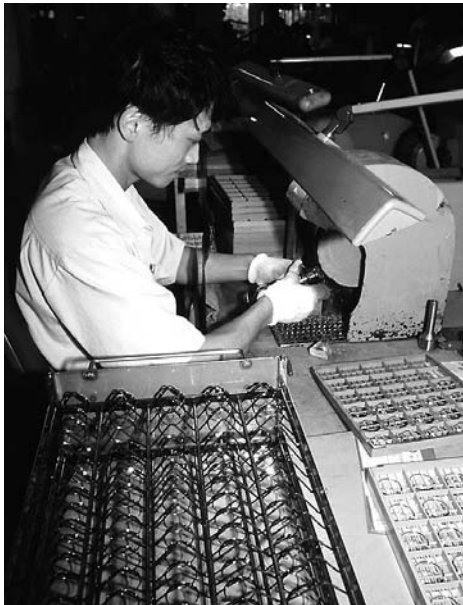
(上) 時計のガラスふち、裏ぶた等の製品を研磨する橋本高史さん (下) 超音波洗浄された時計部品。次の工程への準備をする猪越勝子さん
