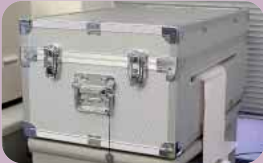
点字プリンター。点字印字の際、かなり穿孔音がうるさいため、点字プリンターは厳重な防音箱の中に設置され、印刷中も蓋が閉まっている。
