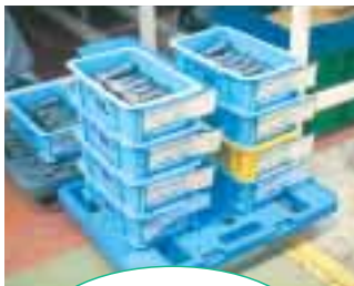
車椅子使用者でも部品を楽に移動できるように、専用の台車を用意。
