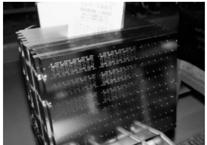
(上) 極小の穴の開いたプリント基板。この穴にメッキする (下) スルーホールメッキされ、出荷される
