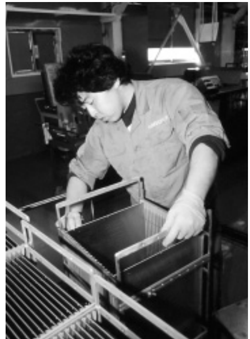
(上) 基板の水洗い、乾燥機に製品を入れる鈴木則克さん (下) メッキされる基板の前処理作業をする河本侑治さん
