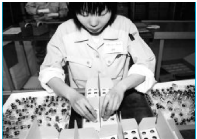
両手で電球の検査と箱詰め作業をする鈴木さん。 1日に平均1万2000個も箱詰めする
