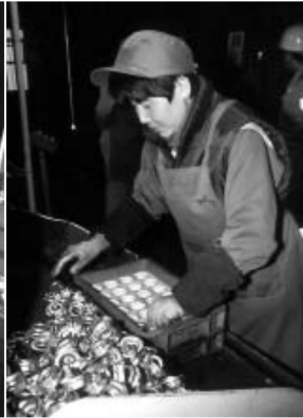
NCナット自動加工機への粗材供給整列作業を行う九渡(くわたり)美智子さん(左上)と岡田ゆりさん
