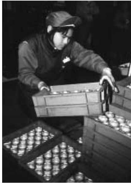
NCナット自動加工機への粗材供給整列作業を行う九渡(くわたり)美智子さん(左上)と岡田ゆりさん
