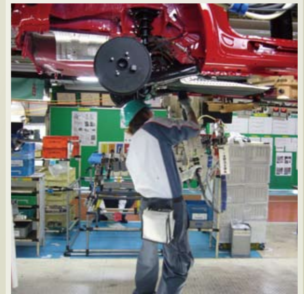
足回り部品の組み付け作業
