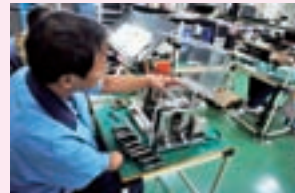
②金属枠をマウントにセットする
