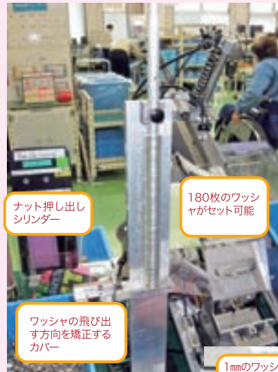
1mmのワッシャが抜ける隙間を確保
