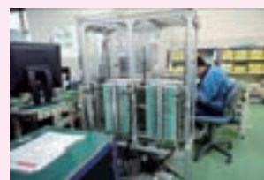
バーコード読み取りにより使用部品や治具の収納トレイが棚から押し出される
