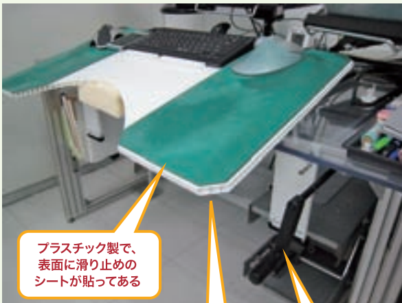
両前腕を安定させるためのアームスタンド状態に合わせ傾斜している
