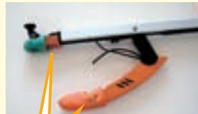
マジックハンドの両先端にゴムサックを付け、滑らないよう工夫
