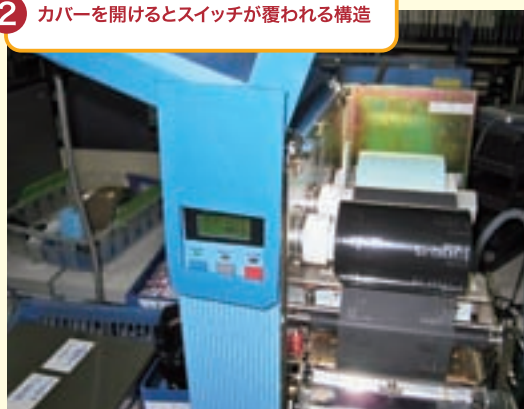
② カバーを開けるとスイッチが覆われる構造
