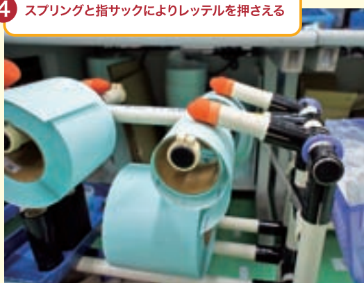
④ スプリングと指サックによりレットルを押さえる
