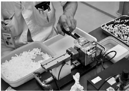
チューブ挿入治具：エアを利用したジョイント挿入工程 (手指機能の弱い人でも簡単に)
