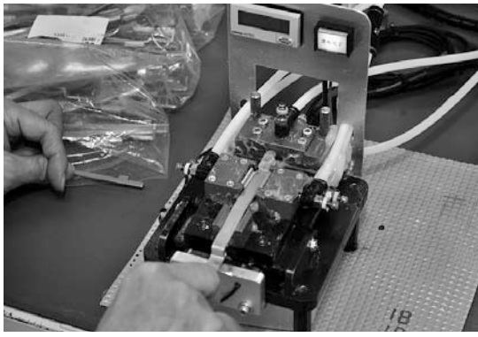
グリス塗布装置：刷毛による手塗り作業を解消（セットするだけで簡単にグリス塗りが可能）
