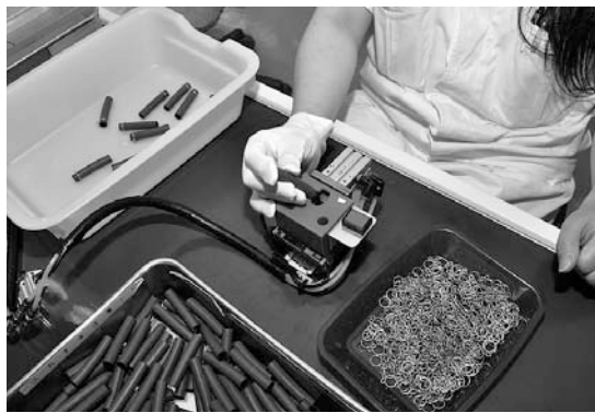
クリップ挿入機：工具を使わず簡単にクリップ付けが可能 (片手作者や知的障害の人も)
