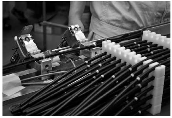
マーキング装置：チューブをセットすると自動的に回転しマーキングが可能（手の震えやアテトーゼのある人へ）
