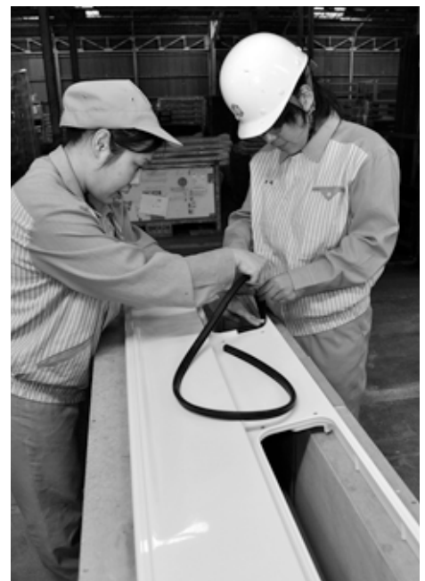
新入社員の岡崎美紀さん（右）と、指導にあたる渡部美和さん。ゴムパッキンの取付け作業をする
