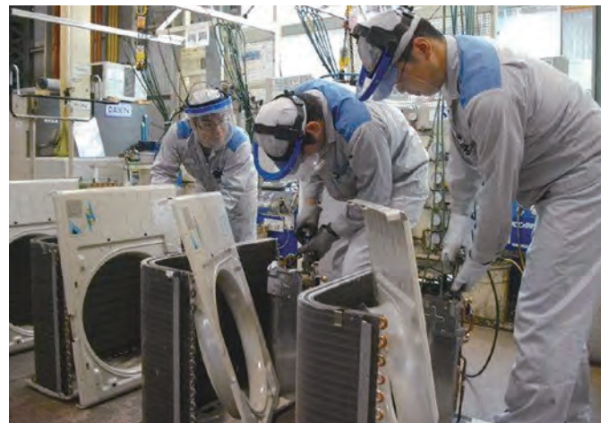
▲冷媒ガス回収作業の様子
