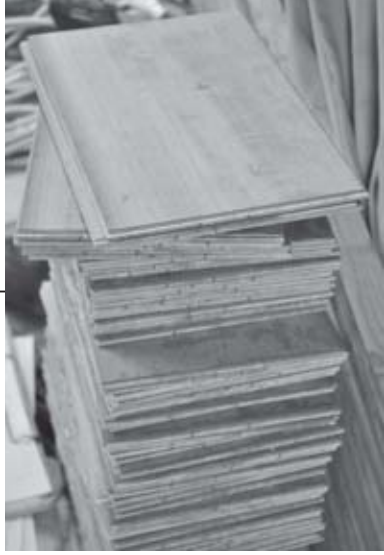
堀さんが担当する卓球のラケット。 製作中の板が貼り合わされ準備されている
